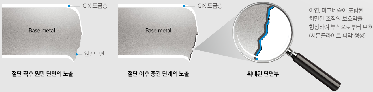
전단면 부식 방지 메커니즘 (Self-sealing Active Mechanism)
