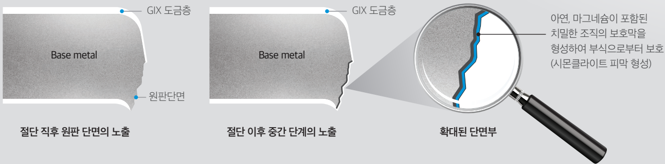
전단면 부식 방지 메커니즘 (Self-sealing Active Mechanism)
