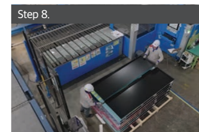
순서별 포장 현장 시공 순서 고려 및 파손 방지를 위한 패널 적재 / 포장
