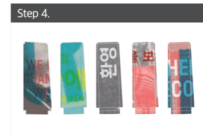
이미지 매칭 1,428개의 이미지를 51개 타입의 패널에 1:1 매칭하고, 1~1,428번까지 작업순서를 배정하여 코일생산이미지를 저장
